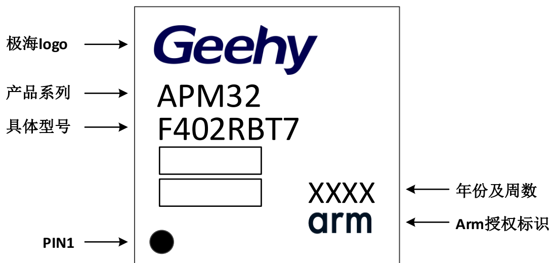
图 18 LQFP64 - 64 引脚，10 x 10mm 封装标识
