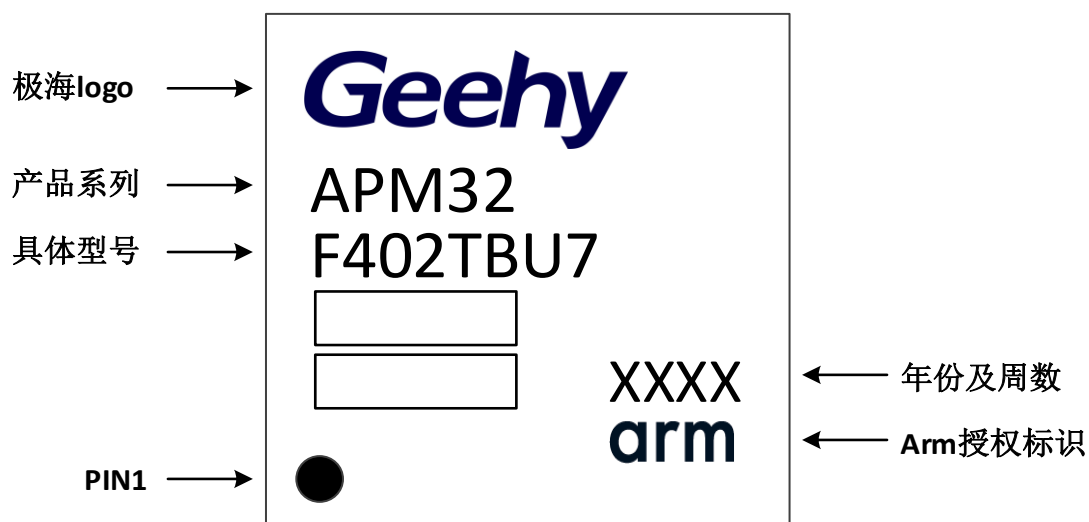
图 27 QFN36-36 引脚 6×6mm 标识图
