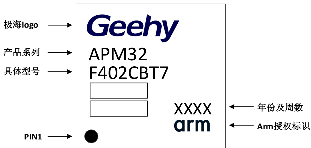
图 21 LQFP48-48 引脚, 7×7mm 标识图
