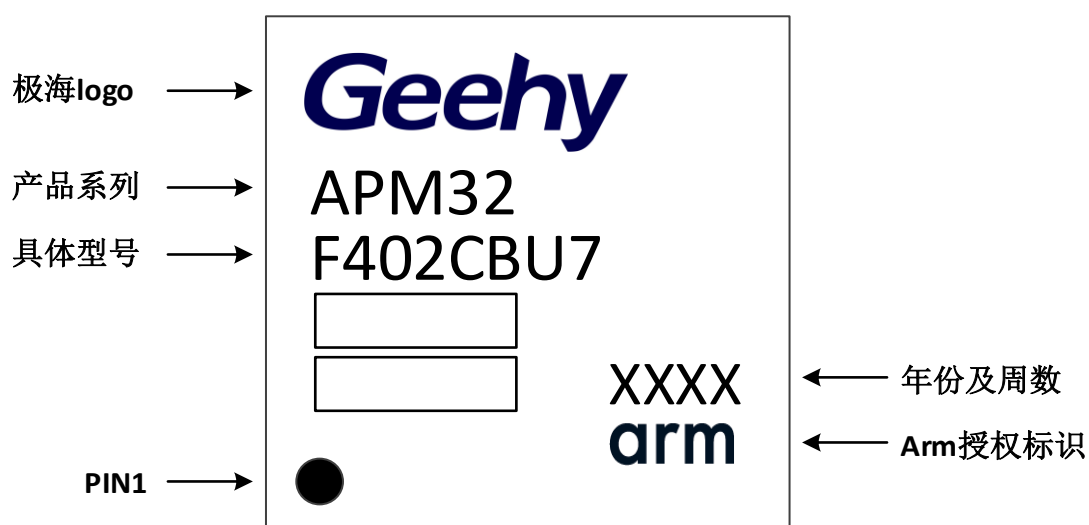
图 24 QFN48-48 引脚 7×7mm 标识图
